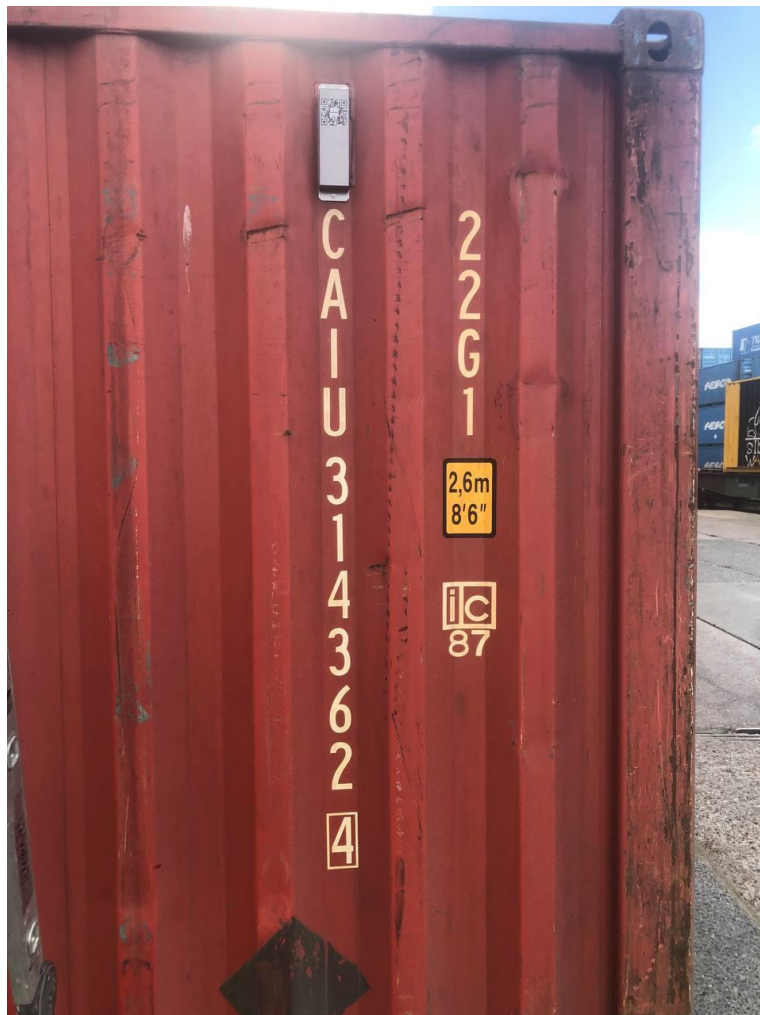
Рисунок 3. Пример выполненной установки трекера на контейнер.
