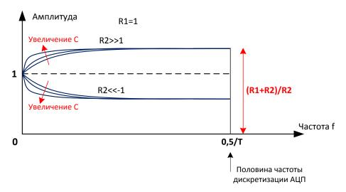
На графике выше и далее: Т—период дискретизации соответствующего цифрового фильтра (равный периоду преобразования АЦП цифрового тракта). Соответственно,
