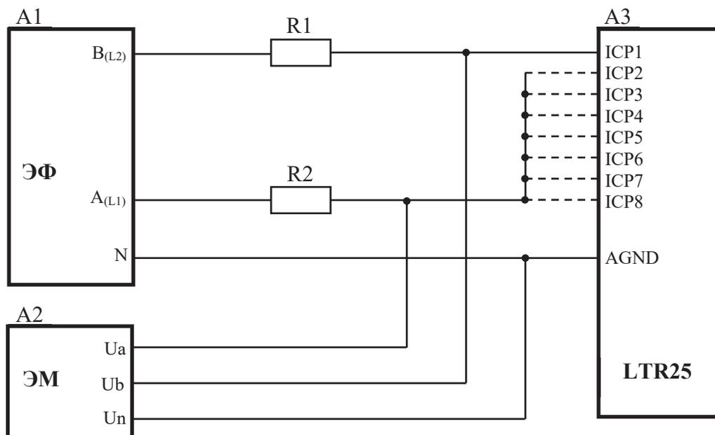
A1 – блок генератора-синтезатора Энергоформа-3.3;
