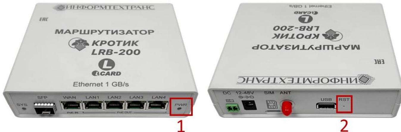
1. Индикатор питания маршрутизатора PWR — отображает текущее состояние устройства
