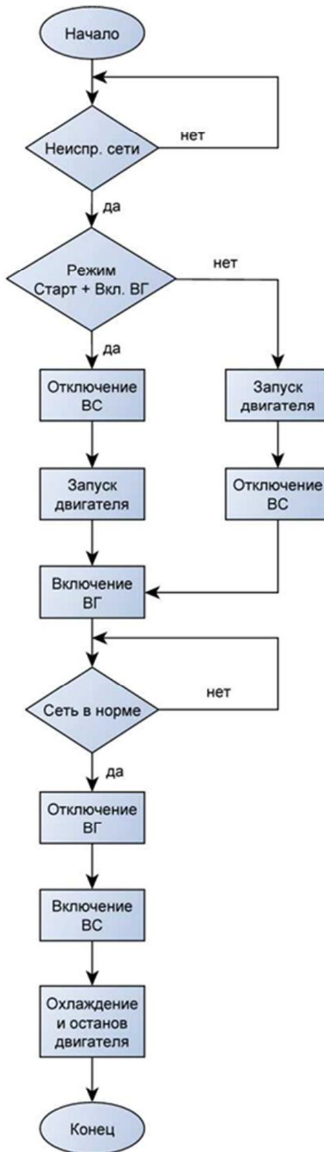
Рисунок В.3 – Блок-схема алгоритма для режима «АВР»
