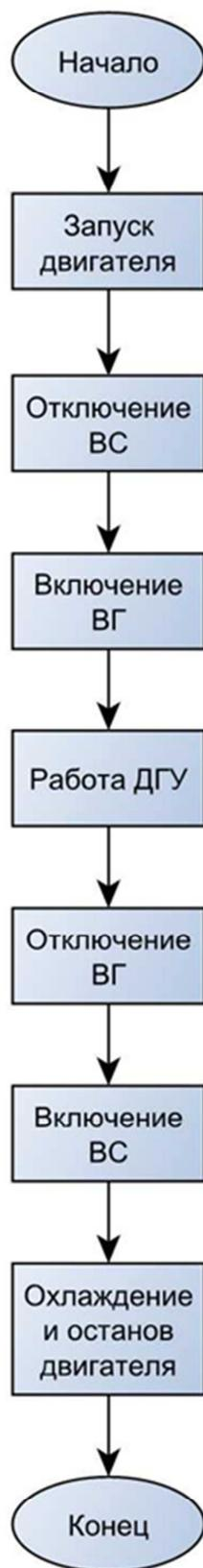
Рисунок В.2 – Блок-схема алгоритма для режима «Перевод нагрузки»
