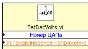
3.2.4.1. Назначение. Устанавливает требуемое напряжение на ЦАПе.
