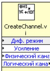
3.1.4.1. Назначение. Создает номер канала АЦП, в который входит как номер канала, так и диапазон.
