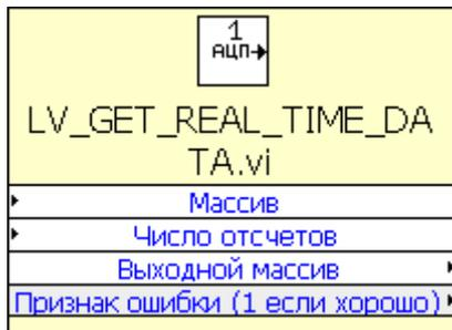
3.3.5.1. Назначение. Прибор используется для вычитывания буфера реального времени, в который помещаются данные с АЦП в фоновом для LabView режиме (т.е. во время ввода данных с АЦП работа LabView не приостанавливается).
