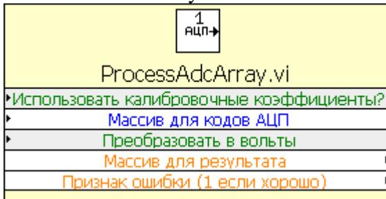
3.4.1.1. Назначение. ВП осуществляет преобразование кодов АЦП в физическую величину с возможностью использования калибровочных коэффициентов, прошитых в E14-440. Данный ВП будет корректно работать только при условии, что предварительно при помощи ВП LV\_SET\_ADC\_SYNCHRO\_READ\_PARAMETERS.vi были заданы параметры ввода, соответствующие параметрам, при которых был собран передаваемый в ВП Массив для кодов АЦП (по сути, описываемому ВП необходимо знать число каналов и массив с каналами АЦП).
