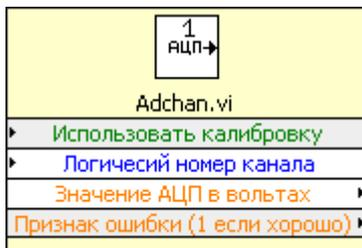
3.2.1.1. Назначение. Выполняет асинхронный ввод данных с указанного канала АЦП.
