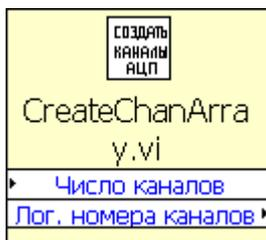
3.1.3.1. Назначение. Вспомогательный прибор, в котором создается массив с номерами каналов АЦП для последующего использования в других приборах. Данная функция создает номера каналов с диапазоном измерения +/- 10 В.
