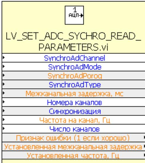
3.3.1.1. Назначение. Устанавливает параметры синхронного ввода с АЦП (частота дискретизации, номера вводимых каналов, тип синхронизации и т.п.).
