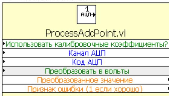
3.4.2.1. Назначение. ВП осуществляет преобразование кода АЦП в физическую величину с возможностью использования калибровочных коэффициентов, прошитых в E14-440.
