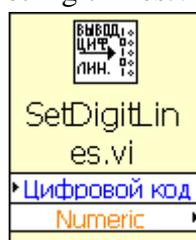
3.2.3.1. Назначение. Асинхронное управление 16-ью выходными цифровыми линиями.
