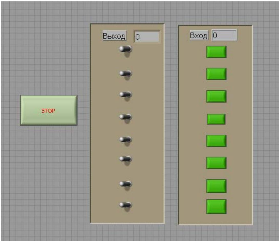
2.4.2. Краткое описание. В данном примере демонстрируется использование асинхронных функций чтения и записи цифровых линий модуля E14-440.
