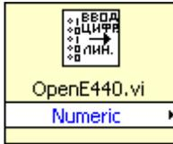
3.1.1.1. Назначение. Данный прибор инициализирует связь с модулем E14-440. Его следует вызывать один раз перед использованием остальных виртуальных приборов.
