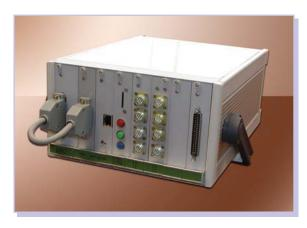
Универсальность системы определяется также возможностью подключения самых разнообразных датчиков - механических деформаций, сил, давлений, виброускорений, угловых скоростей, перемещений и других физических величин. Система обеспечивает возможность работы каждого измерительного канала с мостовыми, полумостовыми, четвертьмостовыми и потенциометрическими резистивными датчиками, а также с датчиками, имеющими выходной сигнал в виде напряжения.
